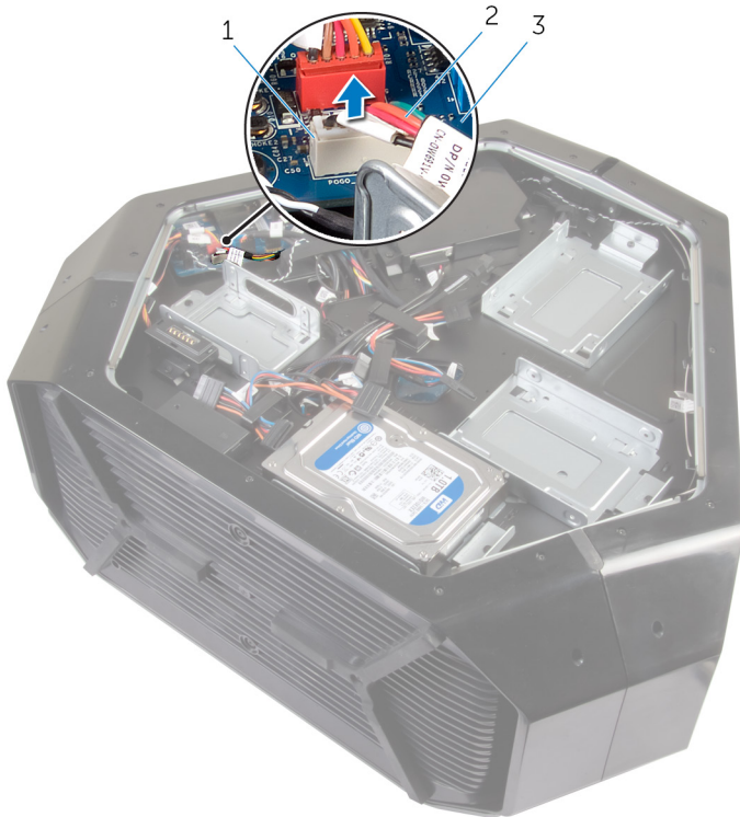
図 17. 画像 : 左側の AlienFX コネクタの取り外し
