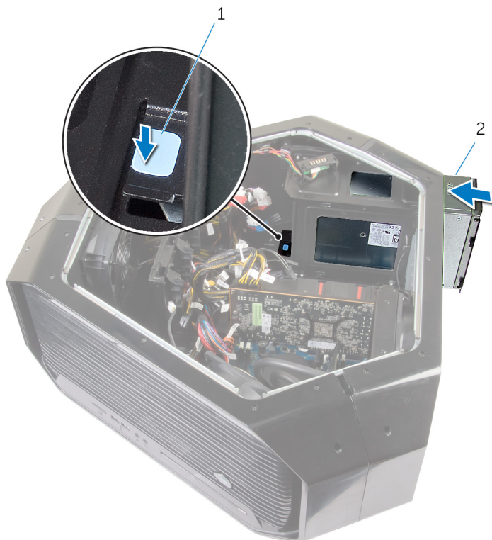
図 50. 電源装置ユニットの取り付け
