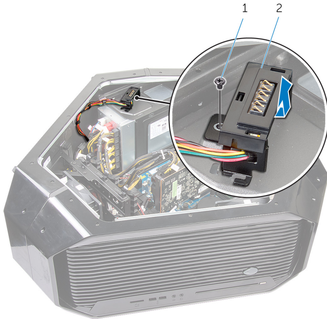
図 18. 画像 : 左側の AlienFX コネクタの取り外し
