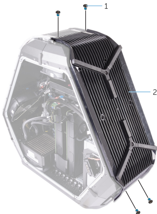
図 70. ベースパネルの取り外し
